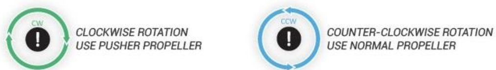
Figura 24 – Sentido de giro de las hélices
