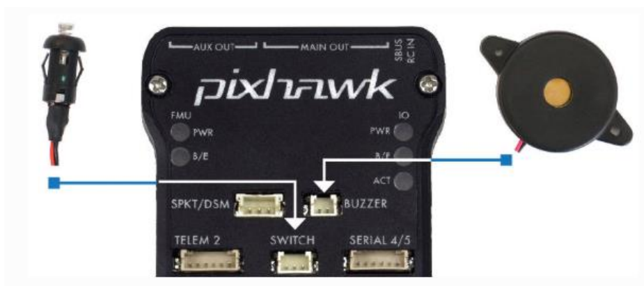
Figura 22 – Conexiones del Buzzer y Switch de armado
