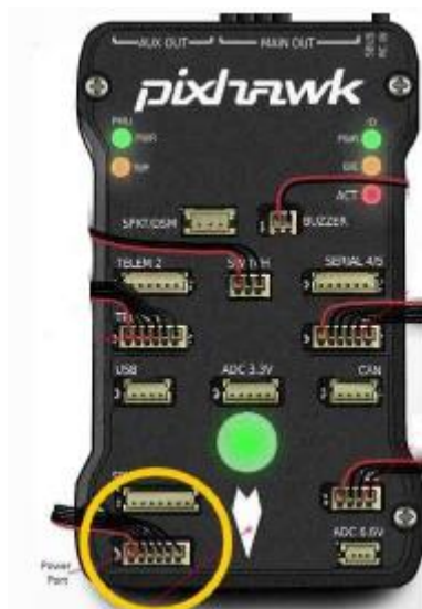
Figura 21 - Alimentación de la Pixhawk
