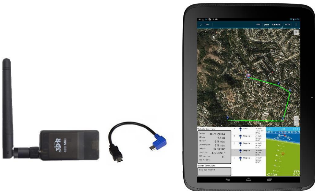
Figura 74 – Conexión del módulo de telemetría a una Tablet Android
