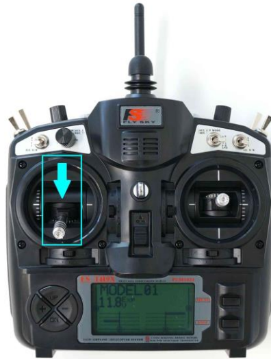
Figura 48 - Paso 3 Calibración ESC
