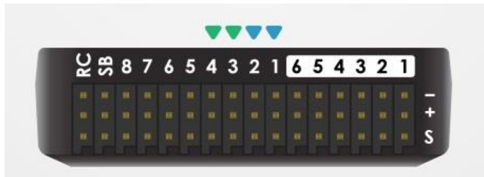
Figura 23 – Conexiones de motores a la controlado
