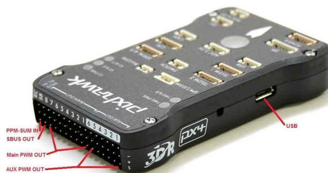
Figura 56 - Conectores Pixhawk PWM para servos y ESC y entrada PPM-SUM y salida SBUS
