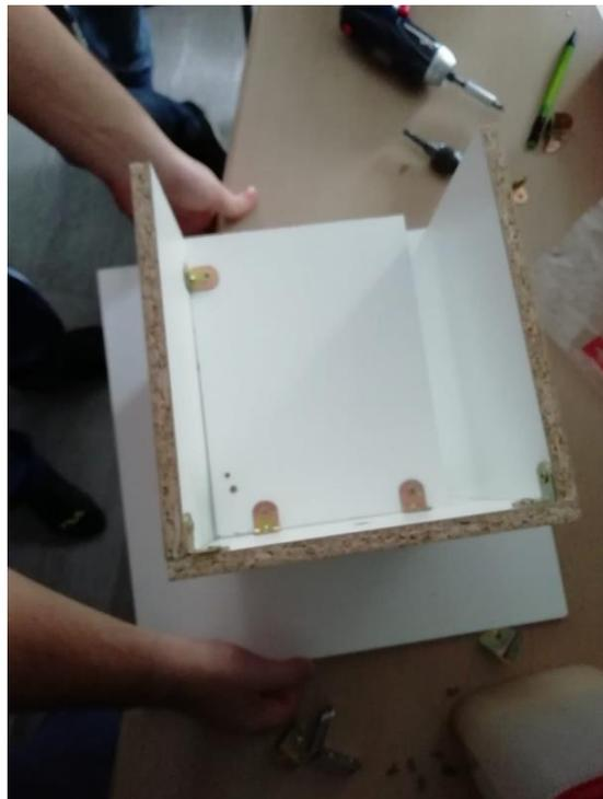
Por último, atornillamos en el interior una balda pequeña como se aprecia en la foto siguiente para que el dispensador posea dos niveles, en el nivel de arriba irá colocada la bomba y el tubo de plástico y en el de abajo el infrarrojo y el resto de los componentes y circuitos como veremos más abajo.
