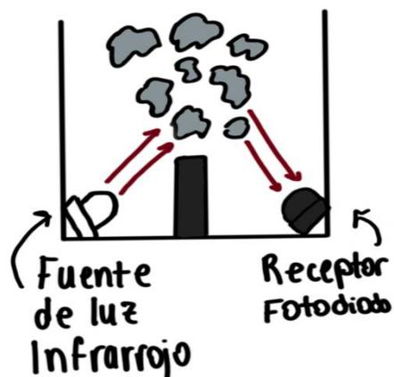
La segunda de ellas es el diseño 3D. Tanto el gato como la recámara para el infrarrojo y el fotodiodo han sido desarrolladas con la aplicación Fusion 360.
