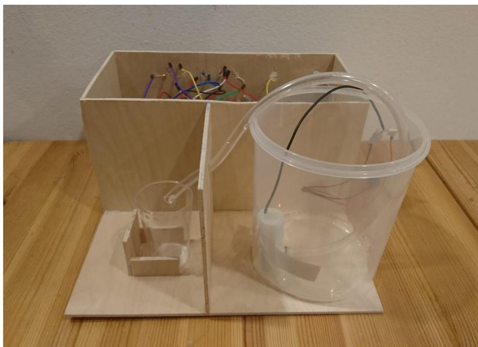
En el interior de la caja se encuentran todos los componentes electrónicos y todas las conexiones. De tal forma que quedan aislados de posibles vertimientos de la bebida.
