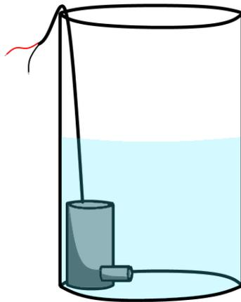
Para evitar repetir este problema, se ha utilizado un recipiente mucho más grande para instalar la bomba; y se ha evitado que el nivel de agua del recipiente alcance la parte superior de la bomba.
