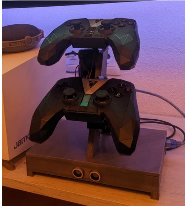
Al acercarse el usuario, los mandos se mueven para poder ser recogidos con mayor facilidad. Al colocarlos de vuelta, las plataformas que sujetan los mandos se retraen y los cables de carga magnéticos se conectan automáticamente a los mandos.
