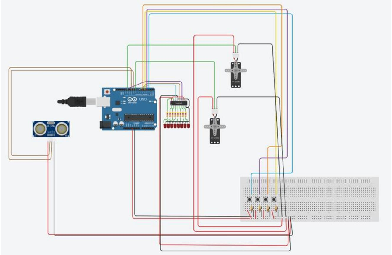
Los servos están conectados a la placa Arduino Uno directamente, al usar sólo dos servos no hace falta una placa driver dedicada. Se utilizan dos pulsadores como detectores de fin de carrera para cada servo, con resistencias para obtener señales HIGH y LOW que pudiera leer el Arduino y poder ser utilizadas en el código de control.
